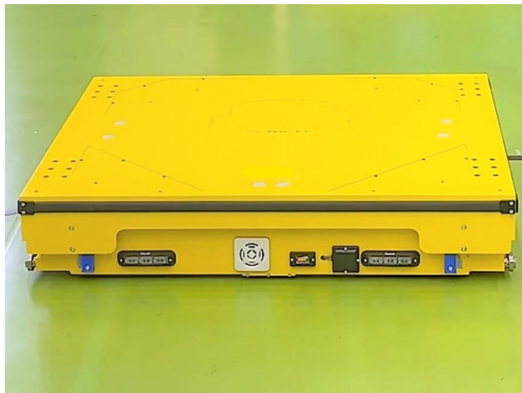
可搬重量1tタイプ搬送ロボット『低床型1tAGV』
