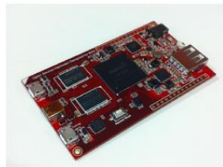
Mozilla Factory が現在開発中の Firefox OS を組み込んだ WoT 向けボード
