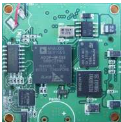
図 4 虹彩認証エンジンモジュール (40mm×40mm 世界最小)
