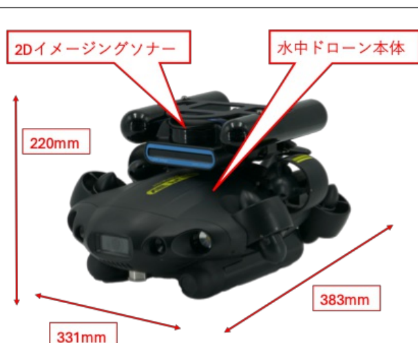
2Dイメージングソナーを搭載した水中ドローン
