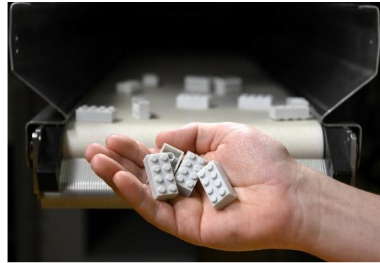
使用済みペットボトルを再利用したレゴ®ブロックの試作品
