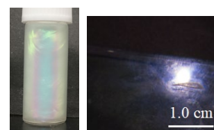
構造色を発しているペロブスカイトナノシートのコロイド溶液（左）とこれを固定したゲル膜の写真
