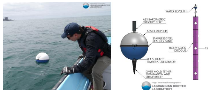
図2 SVP 漂流ブイ。水面下に測定装置が繋がれ、衛星通信で位置や水温などのデータが収集される。一定規格のこのようなブイが世界中の海を何千個と漂っていて、海の現状をモニタリングしている(参照： https://www.aoml.noaa.gov/phod/gdp/ )。画像提供：Global Drifter Program/Lagrangian Drifter Laboratory, Scripps Institution of Oceanography, University of California San Diego ( https://gdp.ucsd.edu/ldl/ )
