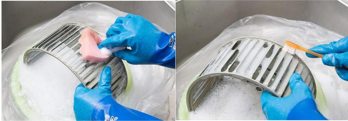
ポイント：汚れがひどい場合は、大きなごみ袋（目安 75ℓ 以上）にぬるま湯をはり、中性洗剤を溶かし浸け置きすると、固まった油が柔らかくなり汚れが落としやすい。
