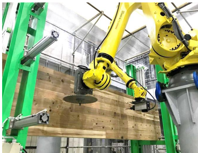
ロボットアーム型加工機「WOODSTAR(ウッドスター)™」
