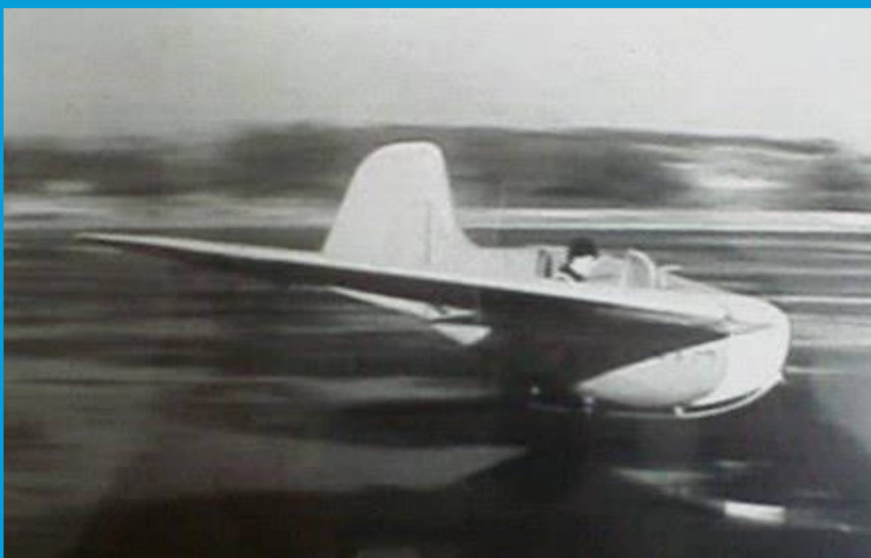
ゴム索曳航で飛行するHK1。1938～39年頃 (木村秀政著「我がヒコーキ人生」 日本図書センター)
