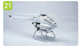
21 ヘリコプター専用フライトコントローラを採用したシングルローター型ドローン「PDH-GS120」 高い飛行性能と耐風性能を有しながら、飛行時間2時間の自動飛行を実現。離島間や孤立地区への物資輸送、広域監視任務に最適。
