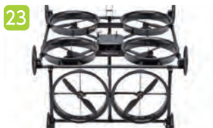
23 壁をよじ登る自走式張り付き型ドローン「PD6-CI-L」 橋梁検査のみならず、一般建築物の壁面検査等にも幅広く使用することが可能。
