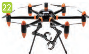
22 ロボットアームを備えた直接作業型ドローン「PD6B-AW-ARM」 ドローン自体が自由に動く多関節アームを持つことで一気に多目的型となり、その使用可能用途が無限に。
