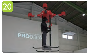
20 対話型パッセンジャードローン「SUKUU」 対象者を載せて安全地帯まで避難。モニターによって、オペレーターと常にコミュニケーションをとることが可能となり、安心感を与えつつ移動を遂行。
