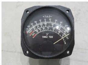
ベル 204B 外気温度計 （排気温度限界表示）
