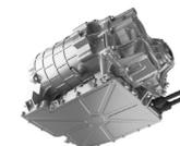
高電圧のソリューションとして、ヴァレオ・シーメンスeAutomotiveの**高電圧電動アクスル**を日本で初めて展示します。これは、出力 100kW のモーター、インバーター、減速機を一体型にした新しい電動アクスルプラットフォームです。モーター、インバーター共用の水冷システムを備えた統合型電動アクスルプラットフォームであり、幅広いパワーレンジとさまざまなドライブトレイン構成に対応可能です。
