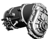
ヴァレオはまた、**48V 電動リアアクスル・ライト**をお披露目します。これは、48Vギアボックスモーター・ジェネレーターをベースにしたフル推進システムであり、ピーク時最大 19kW、連続時 12kWまで対応でき、軽自動車、欧州のL7e規格クラス、中国のLSEVなどの重量 1.2tまでの車両に装備するのに適しています。重量が軽く(25 kg以下)、サイズもコンパクトなので車両に搭載しやすいシステムです。
