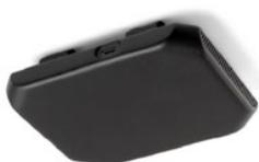
ヴァレオは、先進的な生体検知センサーによる**幼児置き去り検知システム**を日本で初めて出展します。このシステムは、パイヤーイメージングのレーダーセンサーによって、呼吸により車室内の生体を検知します。このレーダーセンサーは、毛布や暗がりで見えない乳幼児でも検知でき、車室内への置き去り防止などに活用できます。これにより、乳幼児が車室内に置き去りになってしまった際に、ドライバーのスマートフォンにアラームを出すなどの活用が可能です。乳幼児やペットが車室内に取り残されて命の危険にさらされる事故は国内外で頻発しており、社会的な問題になっています。幼児置き去り検知機能は、自動車の安全性を評価するユーロ NCAP(ヨーロッパ新車アセスメントプログラム)で2022年よりスコアリング対象になる見込みです。
