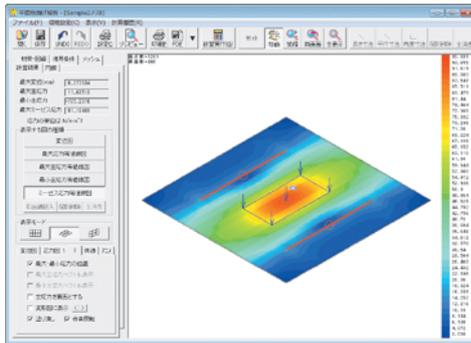
求められる計算結果 最大変位 / 最大主応力 / 最小主応力 / 最大ミーゼス応力
