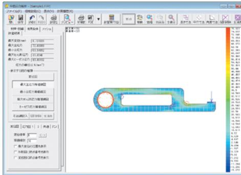
求められる計算結果 最大変位 / 最大主応力 / 最小主応力 / 最大せん断応力 / 最大ミーゼス応力
