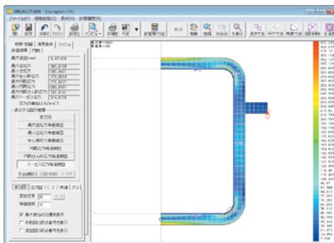
求められる計算結果 最大変位 / 最大主応力 / 最小主応力 / 最大せん断応力 / 最大円周応力 / 最小円周応力 / 最大円周せん断応力 / 最大ミーゼス応力
