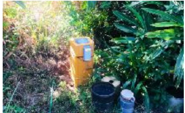
実際に使用している雨量計とIoTセンサ
