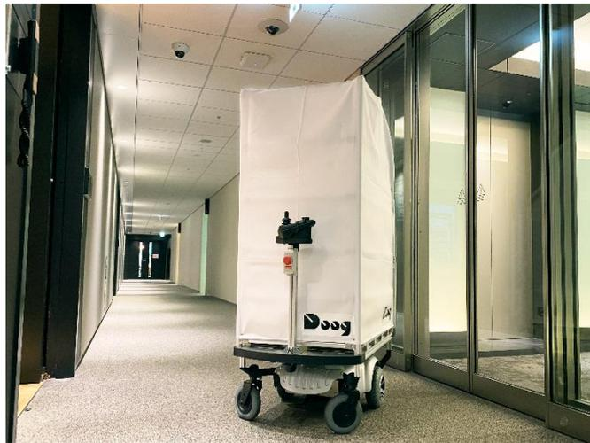
協働運搬ロボット サウザー ～日本橋室町三井タワーにおける実証実験の様子～
