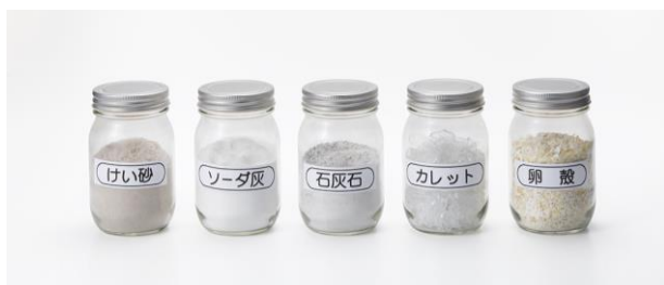
4つの主原料（けい砂・ソーダ灰・石灰石・カレット）及び、卵殻（右端）
