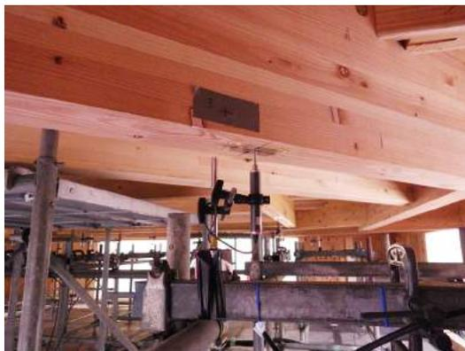
連続斜め梁構法 実大試験 計測機器
