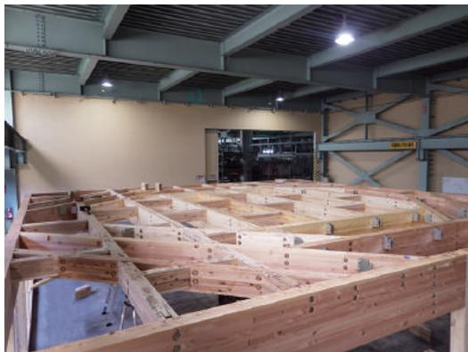
連続斜め梁構法 実大試験体
