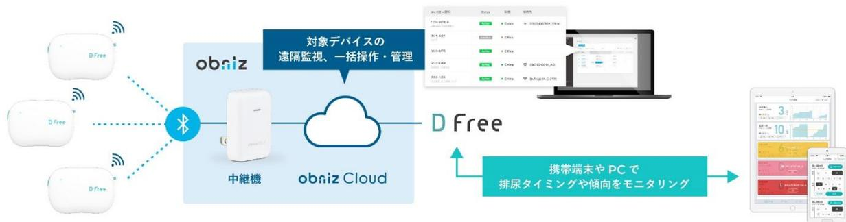
さまざまな身体状態の被介護者が同じ空間にいる、介護施設や医療機関。排尿予測デバイス『DFree Professional』なら、膀胱の膨張・収縮度合を超音波センサで常時検知してデータを可視化させ、ご利用者それぞれの排尿タイミングや傾向を1台の携帯端末から確認できます。obnizは、超音波データの高速で頻回な通信を安定化させる環境構築も実施し、『DFree Professional』の機能を裏側から支えています。
