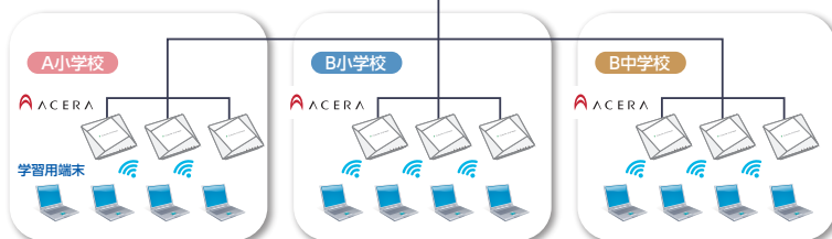
小学校14校と中学校5校に設置した約450台のアクセスポイントを集中管理
