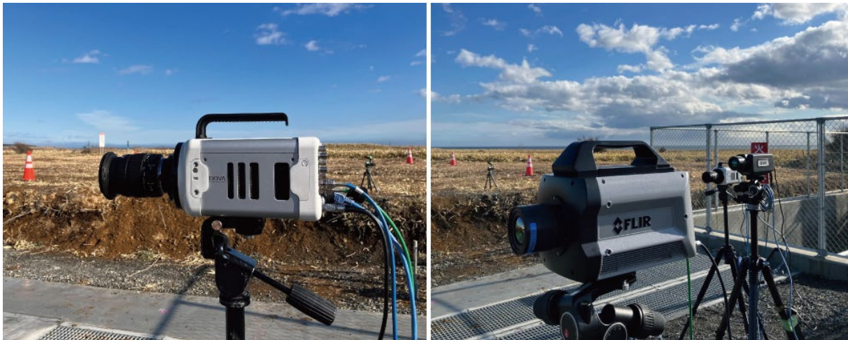
図 1.高感度ハイスピードカメラ(左)と赤外線ハイスピードカメラ(右)の設置風景
