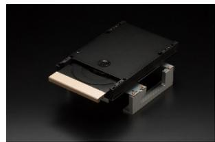
させています。2mm 厚のスチールメカブラケットと最大 10mm 厚のアルミ押し出し材を使用したベースブロックで 2 重構造のボトムシャーシにしっかりと固定することにより優れた制振性を実現。ディスクの回転により発生する振動の周辺回路への影響を抑えるとともに、外部振動からの影響も受けにくい構造としています。読み込みの精度を高めることにより、サーボへの負荷やエラー訂正処理を軽減し、高音質化に貢献します。USB-B、同軸デジタルまたは光デジタル入力を選択されたときには、メカエンジンへの電源供給を停止し高音質化を図っています。
