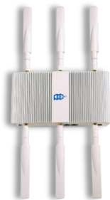
実験で使用した無線LAN アクセスポイント「PCWL-0400」
