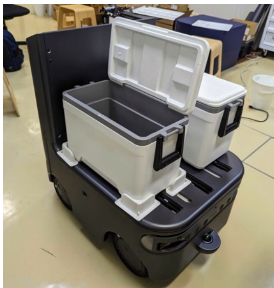
今回の実証実験用に市販のクーラーボックスを荷室として取り付け
