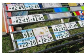
屋外曝露試験
