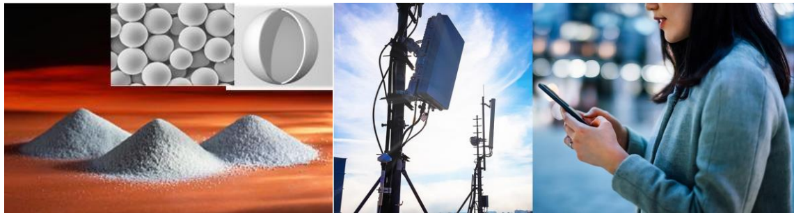
粉末に見える「3M™ グラスバブルズ」の1粒1粒は、微小の中空球となっている
