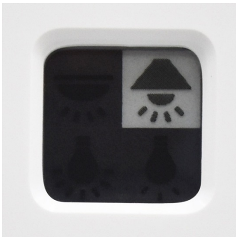
左: 今回開発した電子ペーパーの表示部。セグメント方式のため超低消費電力で駆動する 右: 「第29回 設計・製造ソリューション展」で初公開する電池レススイッチへの展開例
