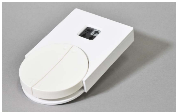
左: 今回開発した電子ペーパーの表示部。セグメント方式のため超低消費電力で駆動する 右: 「第29回 設計・製造ソリューション展」で初公開する電池レススイッチへの展開例
