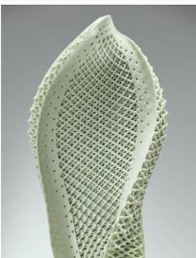
「ADIDAS 4D」は、アディダスが数年間にわたり蓄積した、アスリートの走行データの分析結果に基づき、Digital Light Synthesis(デジタルライト合成テクノロジー)を活用して開発され、UV硬化ポリウレタン混合樹脂を光と酸素で固めた異次元構造の革新的ミッドソールです。このデジタルライト合成により、次世代の3Dプリントともいべき製造工程が可能になり、マイクロメートル単位でミッドソールをデジタル設計しています。
