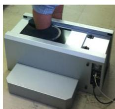
3D 足型計測器による測定
