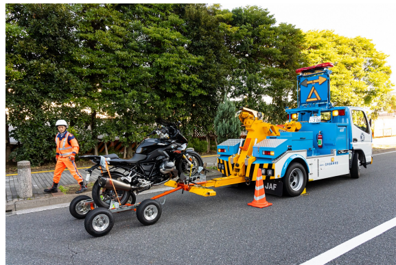
2022年1月から導入された「二輪アタッチメント」 専用の装置にバイクを乗せてけん引する。
