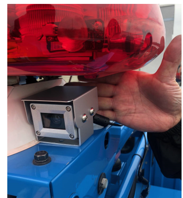
後方警戒装置 車両を検出するカメラ
