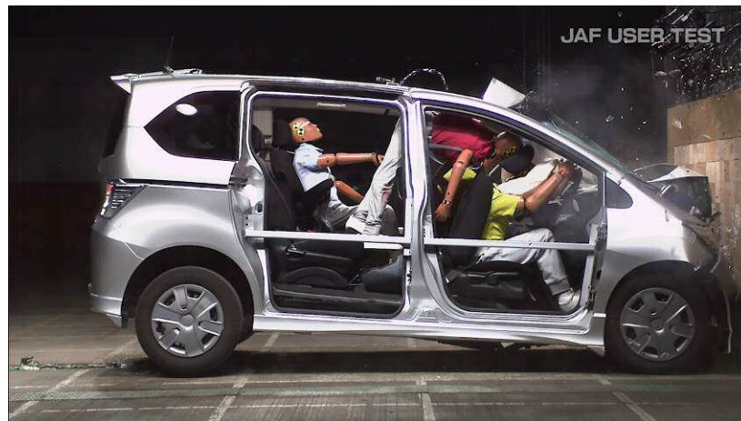
シートベルトを着用していない後席ダミーがシートごと運転席ダミーを押しつぶした
