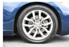
適性空気圧の1/2しか入 っていない50タイヤ。適 性空気圧の50タイヤと見 分けが付きにくい
