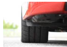
適性空気圧の1/2の45 タイヤ。外見からも見分 けが付きにくい。
