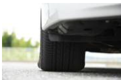
適性空気圧の1/2の65 タイヤ。外見からも見分 けが付きやすい。
