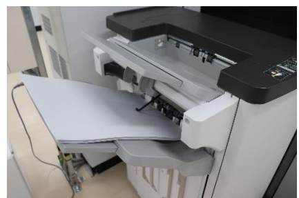
●画像中央・右：セイコーエプソン本社で製紙「PaperLab」に回収したA4古紙を挿入、毎時216枚枚の150g/m 2 ・A3用紙が誕生する。同製品はオフィスでの紙循環を実現しただけでなく、製紙に際して大量に必要となる水もほとんど使わないなど、マルチな点で環境負荷軽減に貢献する（※本体内の加湿に少量の水を使用）。
