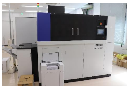
●画像中央・右：セイコーエプソン本社で製紙「PaperLab」に回収したA4古紙を挿入、毎時216枚枚の150g/m 2 ・A3用紙が誕生する。同製品はオフィスでの紙循環を実現しただけでなく、製紙に際して大量に必要となる水もほとんど使わないなど、マルチな点で環境負荷軽減に貢献する（※本体内の加湿に少量の水を使用）。
