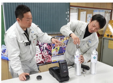
IntelliDOX校正器でBW Soloの校正を行っている永和産業副所長榊原様、工事技術部菅谷様
