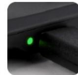
充電完了 緑→消灯
