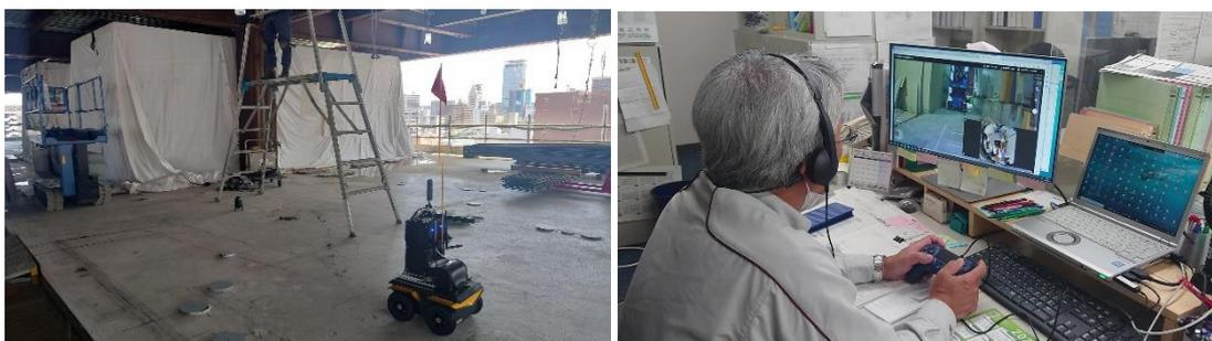
『RemoteBase』は、センシンロボティクスと竹中工務店が開発した誰でも簡単に UGV\*1 を遠隔操作できるソリューションです。現場に限らずインターネットが通じる場所であれば世界中どこからでも点検や撮影、音声でのコミュニケーションなどを可能にします。
