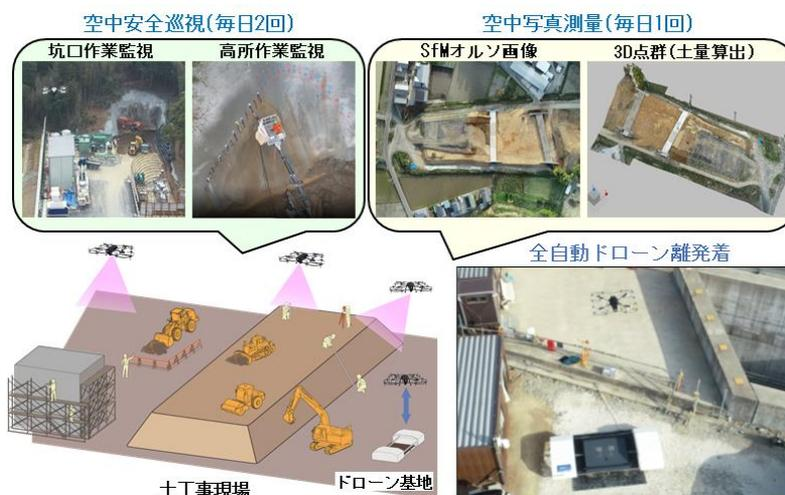
図1 全自動ドローンによる測量・安全巡視
