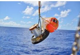
JAXAが宇宙ステーション補給機「こうのとりのり」7号機へ搭載のために開発した小型再突入カプセル。これは、国際宇宙ステーション(ISS)から地上に物資を無事に回収するためのものです。
