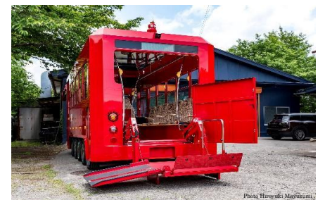
車いすの方もご利用頂きやすいように全ての車両の後部に電動式リフトを装備しています。(※2)
