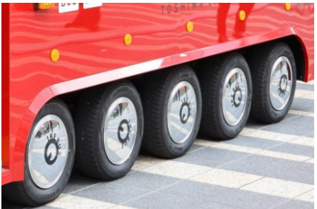
10 輪駆動車。動力源となるのは車輪内に備え付けられた電気モーターです。排ガスを出さない、環境に優しい乗り物です。
