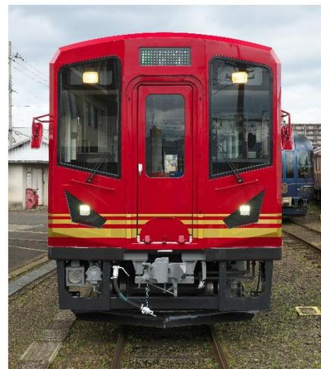
今回導入された新型車両は「丹後の自然と歴史と伝説」をコンセプトとしており、ボディカラーには歴史と伝説の華やかさを表現した鶯赤色を採用し、海のさざ波をイメージした太さの異なる三本の金帯を配しています。車両正面は、大江山の赤鬼・青鬼伝説をイメージした引き締まった顔つきのデザインとなっています。車内は、既存の普通車両の座席数が27席に対し41席と増え、ロングシートと転換シートの2種類を配置しています。転換シートの各席にはUSBポートを配置しスマートフォン端末等の充電が可能となるほか、多機能トイレを設置することでベビーカーや車いすの方も楽にご利用いただけます。さらに、耐雪ブレーキを搭載し、雪の多い沿線でもより安全に運行するなど安全装備も充実しています。当車両は『MF100形』及び『MF200形』の後継車両として入れ替わり、2022年までに同系車両4台を順次導入する予定です。
