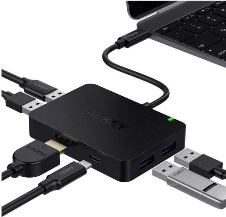
◆【ポートの拡張】USB-C コネクタにより、USB3.0 ポート×4/4K HDMI ポート /USB-C Power Delivery ポートまで接続可能となります。スマホやキーボード等のデバイスを一台でまとめてに接続できます。
