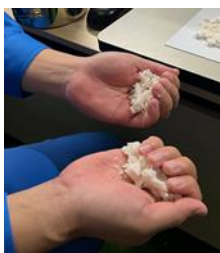
手で握った時の感触で水分含有量を判定する作業
