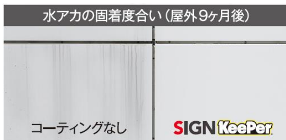
▲コーティング9カ月後の状態。目地の左側がコーティングなしで、右側がコーティングあり。コーティングした部分が全く汚れていないのがわかる。
