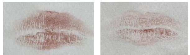
マスクに使用される不織布に口紅を塗布した唇を強く附着させたもの 左：これまでの研究品 右：フィットフィルム処方
