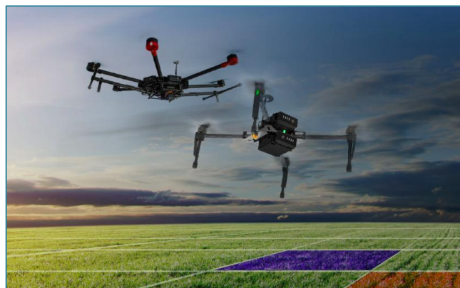
ドローンで農作物のマルチスペクトル画像を空撮し、PrecisionHawk のクラウドサービスで解析
