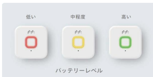
画像：「充電中のバッテリーレベル」
