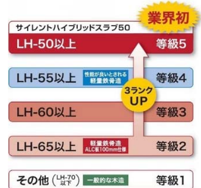
【品確法による重量床衝撃音遮断性能】 3ランク上がることで、聞こえる音は3分の1になります
