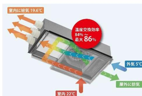
【第1種熱交換型換気システム「風なび RXIII】
