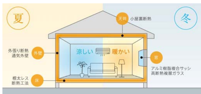
建物の高断熱化によって、省エネで快適な住まいを実現
